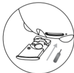
Fig. 3 Compartiment de batterie.
